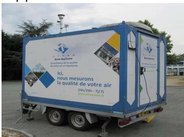
Fig a: Station de contrôle de la qualité de l'air équipée de matériels de contrôls de mesures
